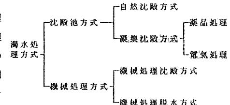
図-1 濁水処理フロー
