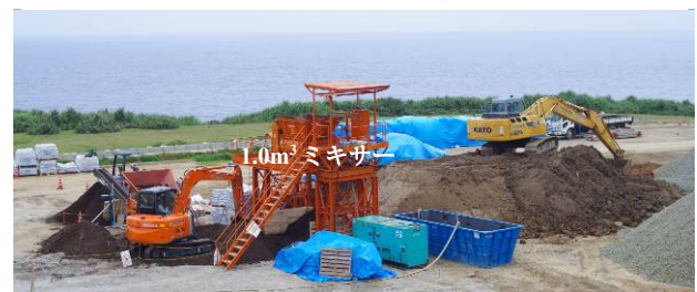
図 3 1.0m 3 の生育基盤製造プラント
