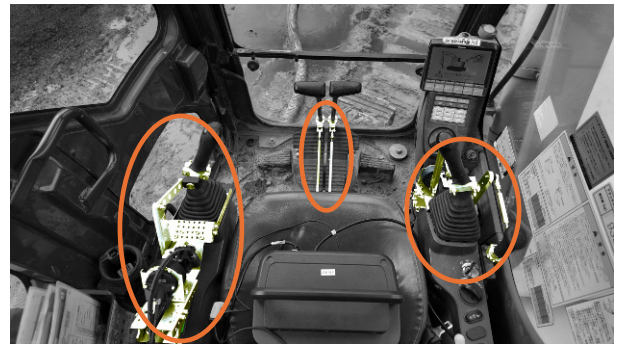
図 18 遠隔操作バックホウの運転席
