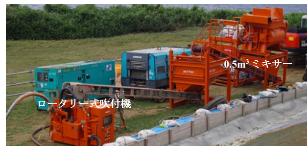
図 2 0.5m 3 の吹付・生育基盤製造プラント
