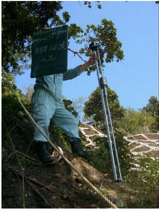
図-2 簡易動的コーン貫入試験機の測定状況
