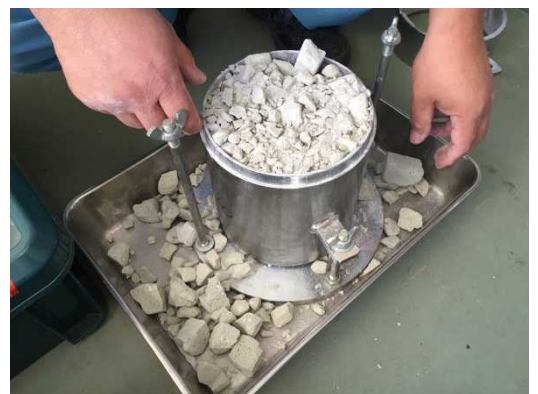
写真-5 突き固め後の状況
