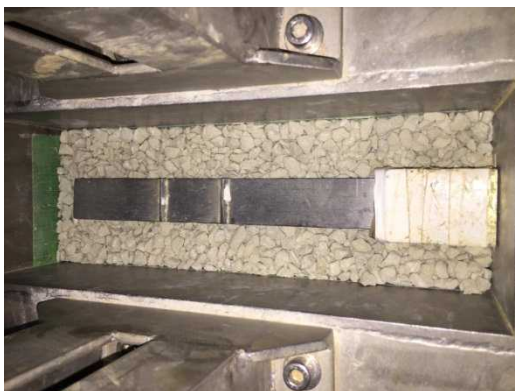
写真-6 補強材の設置状況 (スーパーソル)
